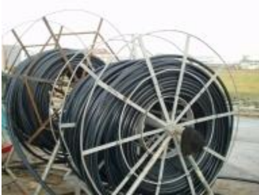
Erdwärmesonden-Schlauchleitung vor dem Einbau
